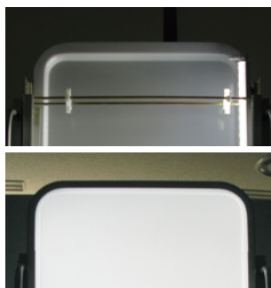
内部に構造物が入っていますが、看板の表示面に影が出ません
